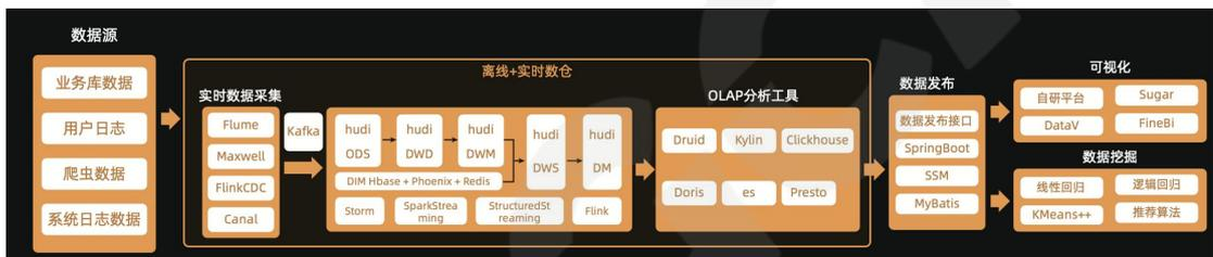
图 3-2 典型的湖仓一体化架构图
