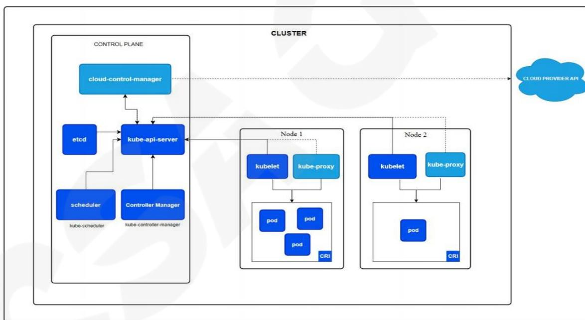
控制平面组件会为集群做全局决策，比如资源的调度，以及检测和响应集群事件。控制平面组件可以在集群中的任何节点上运行。为了简单起见，安装脚本通常会在同一个节点上启动所有控制平面组件，并且不会在此计算机上运行用户容器。节点组件会在每个节点上运行，负责维护运行的 Pod 并提供 Kubernetes 运行环境。
